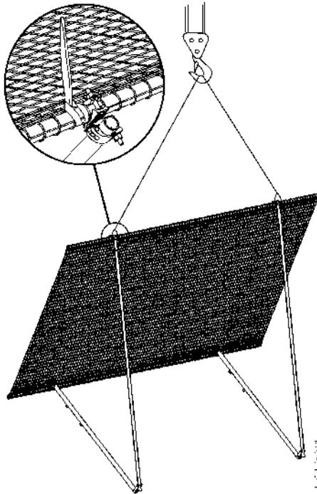
Figure 19. Lifting a safety net fan
